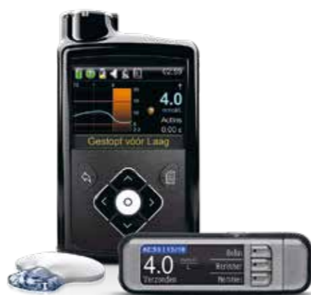
De MiniMed 640 insulinepomp heeft in combinatie met de Enlite sensor een automatische hypostop
